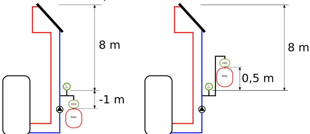
Dabei bedeutet eine negative Höhe, dass z.B. das Ausdehnungsgefäß unterhalb des Manometers montiert ist. Eine positive Höhe bedeutet dementsprechend die Montage des Ausdehnungsgefäß oberhalb (Abbildung rechts) des Manometers.
